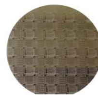
完成水平電極之PN diodes
