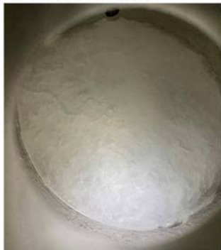
以真空技術製造之冰泥儲冷材料
